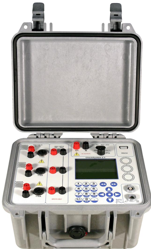
Le système de mesure portable CheckSystem 2.3 comprend un générateur de courant triphasé, ainsi qu'un compteur étalon de classe 0.2. La caractéristique de cet appareil est à la fois son large gamme de mesure, son haut degré de précision et son faible sensibilité aux influences externes.
